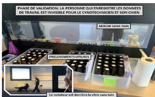
Figure 6 : La phase de validation impose la randomisation du nombre de positifs et de leur position dans la ligne d'olfaction, ainsi que la garantie que le notateur n'est pas en contact avec le cynotechnicien.
